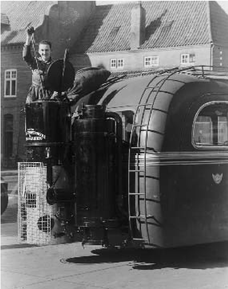
Manglen på benzin skabte basis for en produktion af gasgeneratorer til biler: GYRO fik eneforhandling af Wodskou generatorer, der kunne fungere både på tøv og træ. Her viser mekaniker Peter Iversen en generator på en rutebil, som holder bag Brogården.
